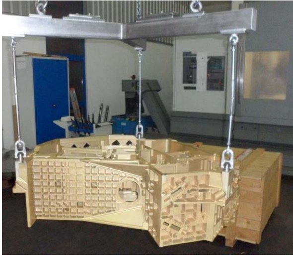
Zentrales hochkomplexes Strukturteil zur Aufnahme der optischen Baugruppen für das Hyperspektralinstrument auf EnMAP
