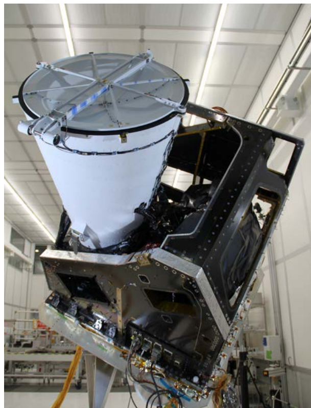
Die Telescope Assembly ist ein Instrument des MTG-Wettersatelliten des Typs „Imager“, welches - vereinfacht gesagt - ein komplexes Spiegelsystem darstellt
