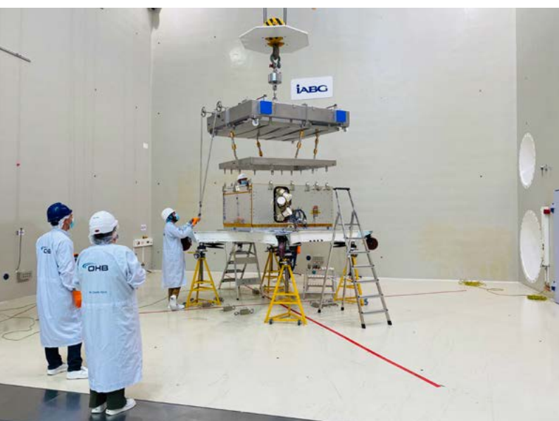
Per Deckenkran wird das EnMAP-Instrument aus dem Schalllabor der IABG geholt
